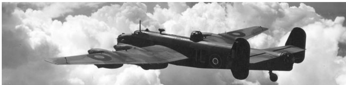
Bombardier britannique Halifax - 4 moteurs de 1 620 cv – 450 km/h à 4 000 mètres d'altitude
